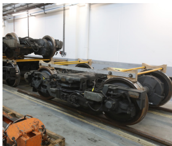
■ Les bogies sur lesquels sont fixés les essieux et les roues sont révisés, réparés et changés à l'atelier de maintenance bouloonnais.
